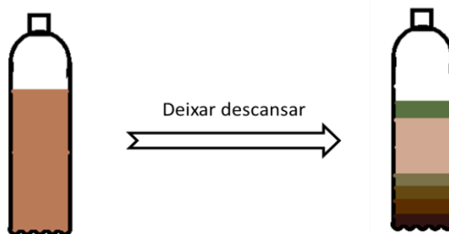
Figura 3 – Ilustração da possível decantação da dispersão de solo em água
