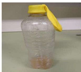
Figura 2 – Arranjo experimental - bexiga com bicarbonato de sódio em seu interior envolvendo o gargalo da garrafa contendo vinagre
