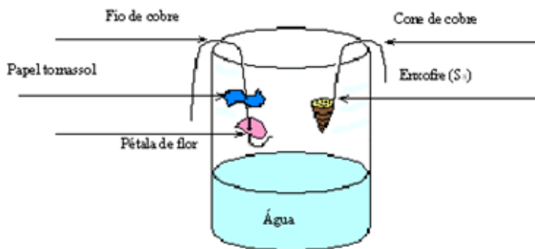
FIGURA 6.2 – ESQUEMA REPRESENTATIVO DO EXPERIMENTO MONTADO. (FONTE: HTTP://WWW.USP.BR/QAMBIENTAL/CHUVA_ACIDAEXPERIMENTO.HTML )
