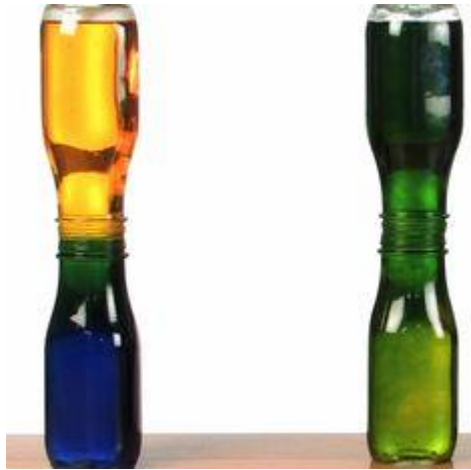
FIGURA 7.1 - GARRAFAS PARA O EXPERIMENTO EM CONTATO. NO PRIMEIRO CASO, COM A ÁGUA QUENTE NA GARRAFA SUPERIOR. NO SEGUNDO CASO, COM A ÁGUA QUENTE INICIALMENTE EMBAIXO. (FONTE: HTTP://WWW.NJFAMILY.COM/NJ-FAMILY/FEBRUARY-2012/SICK-SCIENCE-COLORFUL-CONVECTION-CURRENTS/ )
